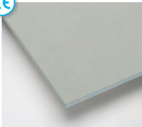
Speciali lastre in gesso rivestito con cartone a basso contenuto di cellulosa, per una totale incombustibilità, e elevate caratteristiche di resistenza al fuoco, identiche alle Ignilastre® GKF (DF). La lastra F-Zero® può sostituire la Ignilastra GKF (F) per ottenere la Classe A1 di reazione al fuoco. Per la corretta applicazione consultare il Settore Tecnico ed i Fascicoli Tecnici.
