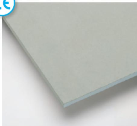
Lastra in gesso rivestito costituite da un nucleo di gesso le cui superfici e bordi longitudinali sono rivestiti da uno speciale cartone a basso contenuto di cellulosa. Essa può sostituire la lastra Knauf GKB (A) per ottenere la Classe di Reazione al fuoco A1. Per la corretta applicazione consultare il Settore Tecnico ed i Fascicoli Tecnici.
