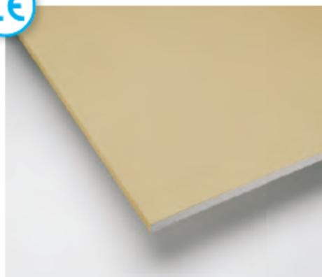
Lastra in gesso rivestito ad alta resistenza meccanica, costituita da un nucleo di gesso ad alta densità le cui superfici sono rivestite da un cartone di colore giallo.
