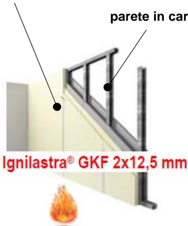
FINITURA SUPERFICIALE: Armatura dei giunti tra le lastre con nastro Knauf e stuccatura dei giunti e della testa delle viti con stucco Knauf a base gesso
